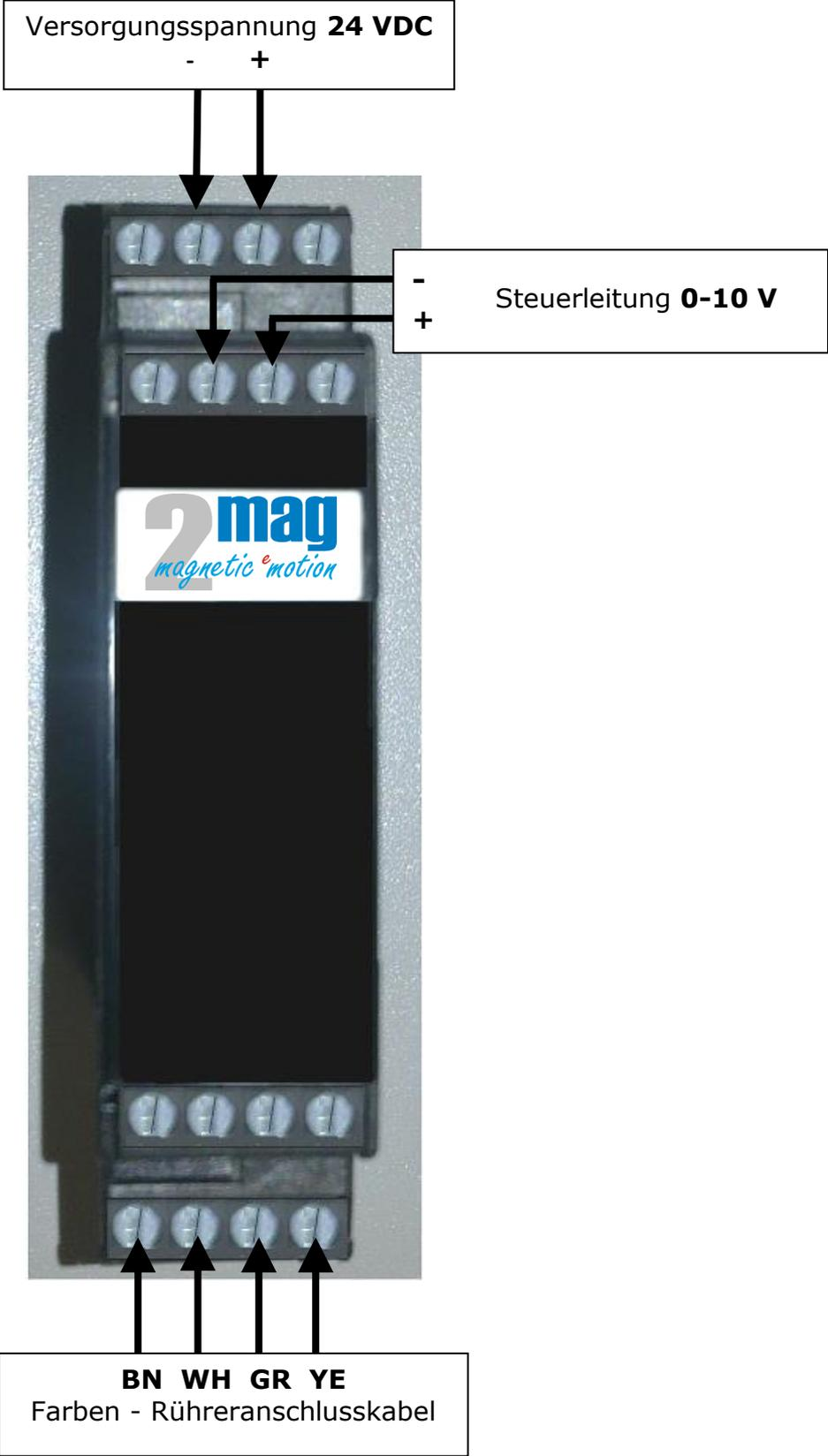
Bild 8: Pin-Belegung MIXcontrol eco DINrail 0-10 V
