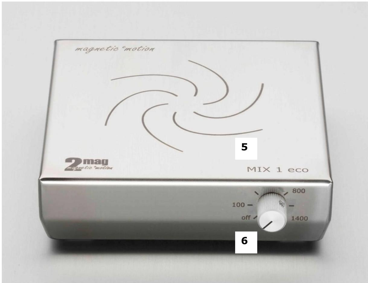
Bild 3: Bedienelemente, Magnetrührer MIX 1 eco
