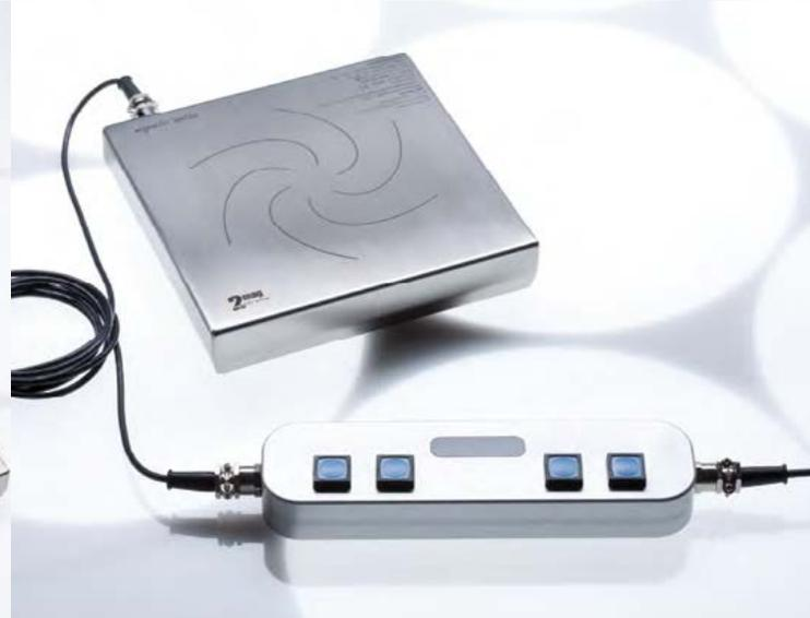
Puissance d'agitation de 20 W, plage de vitesse allant de 100 à 2.000 tr/min, agitation sans secousse même à de faibles vitesses, réglage de puissance en 4 pas.
