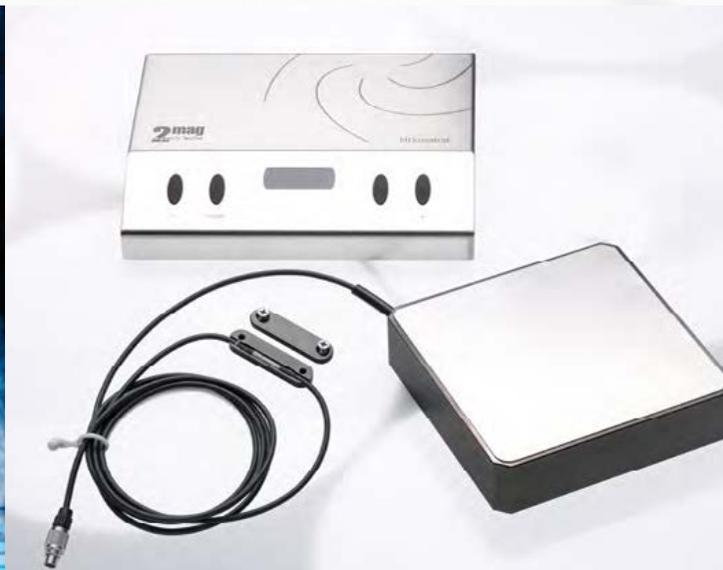
Fonction SoftStart pour une capture/un centrage et une accélération sécurisée du barreau magnétique, intervalles de temps ajustables pour un redémarrage de l'agitateur après une durée d'intervalle jusqu'à 240 secondes. Puissance d'agitation 20 Watt, plage de vitesse de 100 à 1,200 tr/min, agitation sans secousse même à faibles vitesses.
