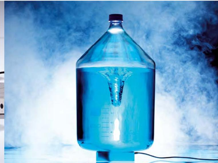
Una innovación absoluta es el mixWATCH, control integrado sin contacto de la barra de agitación. En caso de desacoplamiento magnético del agitador y la barra de agitación durante la fase de aceleración, por ejemplo causada por la elección de una velocidad demasiado alta o por cambios de viscosidad, el agitador se detendrá, la barra de agitación se centrará y el equipo arrancará de nuevo.
